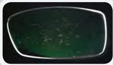
Distacco completo dello strato di Antiriflesso
