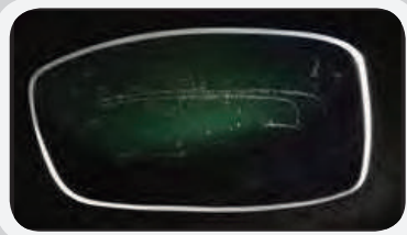
Danni da tensionatura per esposizione a fonti di calore eccessive
